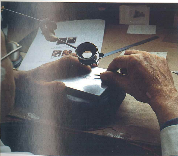
Una vez aprobado el boceto del sello, un grabador realiza la plancha matriz de la que se obtendrán los duplicados.
